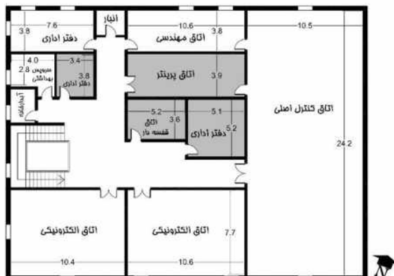
تصویر ۳. پلان طبقه اول ساختمان کنترل نیروگاه، ترسیم شده بر اساس نقشه‌های شرکت سازنده
